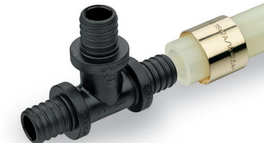
Dans le Système KAN-therm Push, les assemblages sans joint torique et étanches sont obtenus par l'insertion d'une bague en laiton sur le raccord et le tube. Ces assemblages ne demandent pas d'autres étanchéités complémentaires telles que le ruban téflon, de l'étoupe. Ce système est complété par les distributeurs et les coffrets d'installation.
