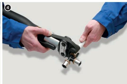
5. Mettre en marche la presse et effectuer le sertissage. Souder jusqu'à une fermeture complète des mâchoires. Une bague ne peut être soudée sur un tube qu'une seule fois.
