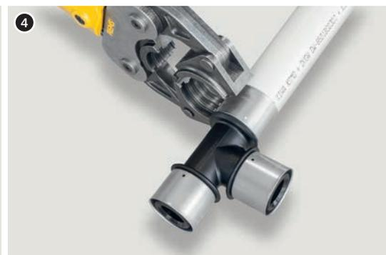
5. Placer la mâchoire de la sertisseuse sur la bague de façon à ce qu'elle touche la bride du raccord. Le bord extérieur de la mâchoire doit toucher la bride du raccord toutefois sans l'entourer. Mettre en marche la sertisseuse et effectuer l'assemblage.
