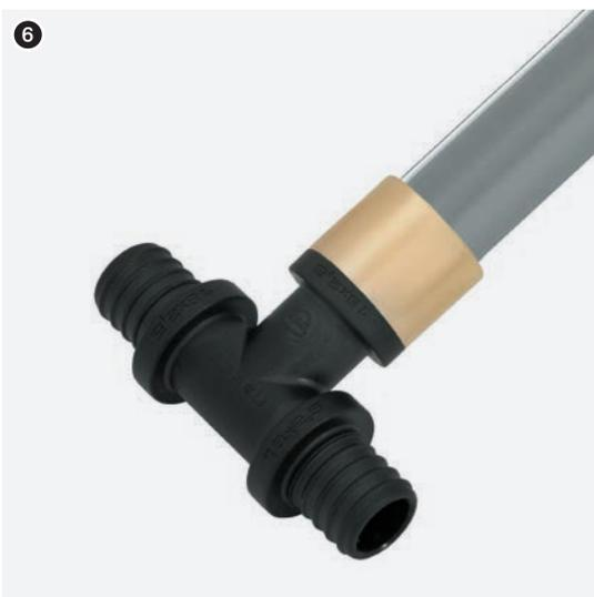
6. Lors de l'insertion de la bague sur le raccord, observer le processus de montage : une fois la bague atteinte la bride du raccord, arrêter l'insertion. L'assemblage est prêt pour un essai de pression.
