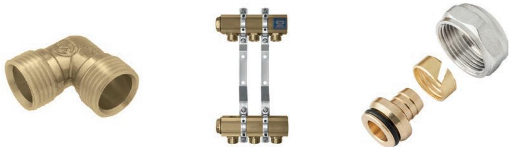
Les raccords unions sont caractérisés par une étanchéité conique et des joints toriques entre le manchon et le raccord. Les assemblages de ce type sont auto-étanches et ils ne demandent pas d'autre étanchéité telle que le ruban téflon ou de l'étoupe. Les assemblages de ce type doivent être placés dans les endroits facilement accessibles.
