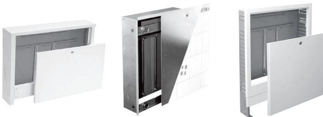
La construction des coffrets du plancher chauffant permet de mettre en place les distributeurs avec ou sans circuit mélangeur. Dans les coffrets, on a prévu également la place pour les borniers électriques. Les borniers électriques sont installés avec des boulons dans les trous prépercés sur le rail de montage dans la partie supérieure d'un coffret.
