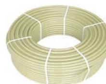
**tube PE-RT selon la DIN 4726 équipé de barrière anti-diffusion selon la DIN 4726 prévu pour l'installation de chauffage central et pour le plancher chauffant pression de service jusqu'à 6 bars**
