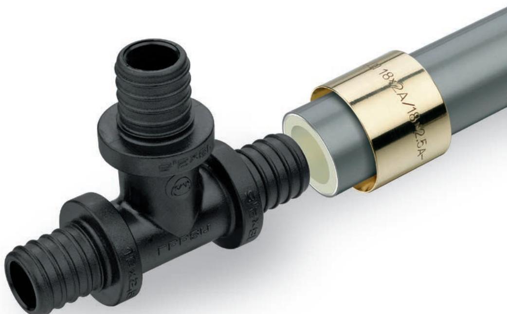
Dans le Système KAN-therm Push Platinum, les assemblages sans joint torique et étanches sont obtenus par l'insertion d'une bague en laiton sur le raccord et le tube. Ces assemblages ne demandent pas d'autres étanchéités complémentaires telles que le ruban téflon, de l'étoupe. Ce système est complété par les distributeurs et mes coffrets d'installation disponibles dans l'espace Distributeurs, coffrets et éléments complémentaires.
