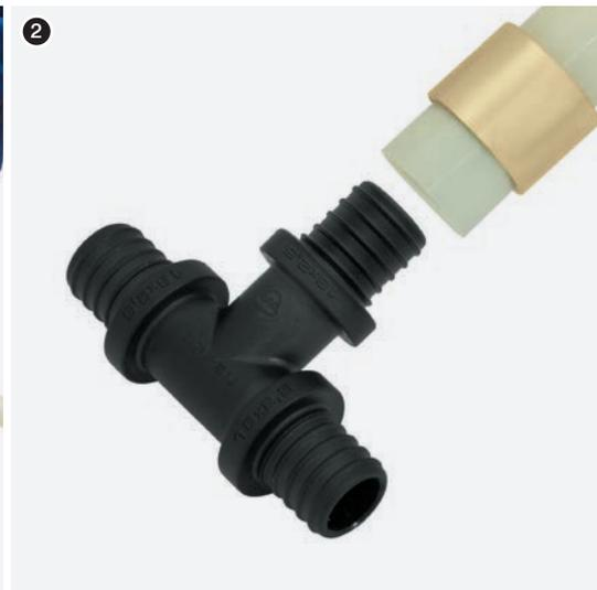
3. Pour écarter un tube, utiliser un outil d'écartement manuel ou sur batterie. Dans les deux cas, l'écartement du tube doit être fait en trois phases. Les deux premiers non complets, tout en retournant l'outil d'écartement par rapport au tube de 30° et de 15°. Le troisième écartement du tube est complet.
