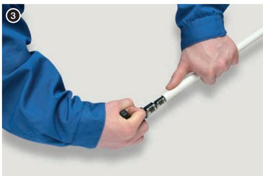
4. Insérer à fond le corps du raccord union (du manchon) à l'intérieur du tube. La profondeur de l'insertion du manchon est d'env. 9 mm pour les tubes Ø14, 16, 20 et de 12 mm pour les tubes Ø25 et 26.
