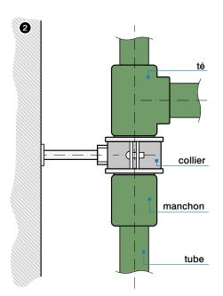
Exemples de pose des colonnes d'installation d'eau chaude en fonction du type de tubes (fig. 3 et 4)
