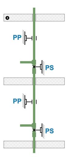
Distances maximales entre les supports des tubes du Système KAN-therm PP Green uniformes en fonction du diamètre et de la temp. du fluide. Pour les fragments verticaux des conduites, il est possible d'accroître l'écartement des supports d'env. 30%.
