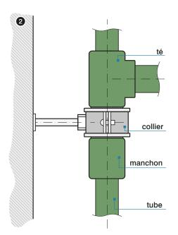
Exemples de pose des colonnes d'installation d'eau chaude en fonction du type de tubes (fig. 3 et 4)
