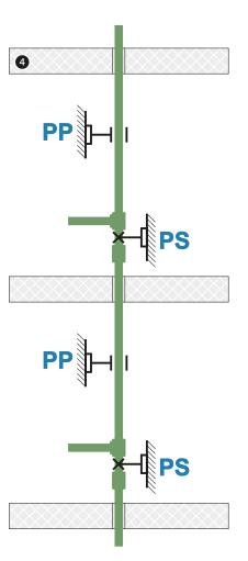
Distances maximales entre les supports des tubes du Système KAN-therm PP uniformes Green en fonction du diamètre et de la temp. du fluide. Pour les fragments verticaux des conduites, il est possible d'accroître l'écartement des supports d'env. 30%.
