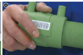
5. Programmation de la machine à souder par l'intermédiaire du lecteur de laser (la machine à souder ajustera des paramètres de manière automatique).
