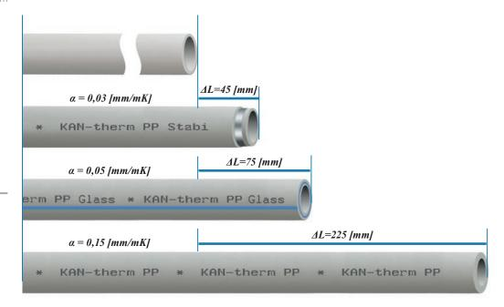
Comparaison de l'allongement thermique des tubes KAN-therm PP homogènes et composites Stabi Al et Glass
