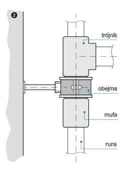
Exemples de l'acheminement des colonnes avec les installations de l'eau chaude en fonction du type des tubes (fig. 3 et 4)
