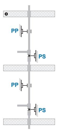
Distances maximales entre les supports des tubes du Système KAN-therm PP homogènes en fonction du diamètre et de la temp. du fluide. Pour les fragments verticaux des conduites, il est possible d'accroître l'écartement des supports d'env. 30%.
