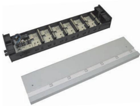
**La barre électrique Basic de chauffage et de rafraîchissement avec module de pompage, en version 230V ou 24V** – permet de raccorder les thermostats et les vérins dans un seul endroit (p.ex. coffret d'installation au-dessus du distributeur). Il est possible de connecter 6 thermostats et 12 vérins au maxi.
