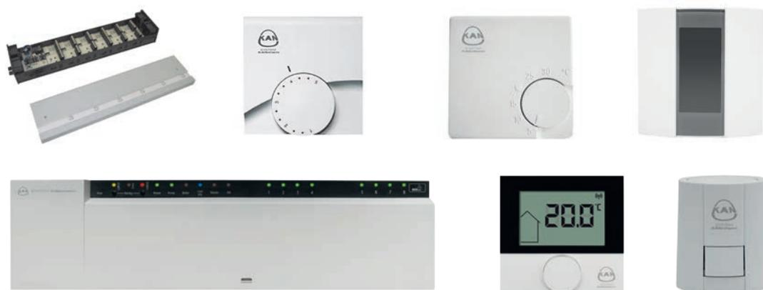
**La barre électrique Basic 230V ou 24V, en version avec ou sans module de pompage –** permet de raccorder les thermostats et les vérins dans un seul endroit (p.ex. coffret d'installation au-dessus du distributeur). Il est possible de connecter 6 thermostats et 12 vérins au maxi.
