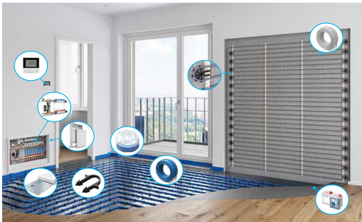
Composants du chauffage/rafraîchissement surfacique KAN-therm
