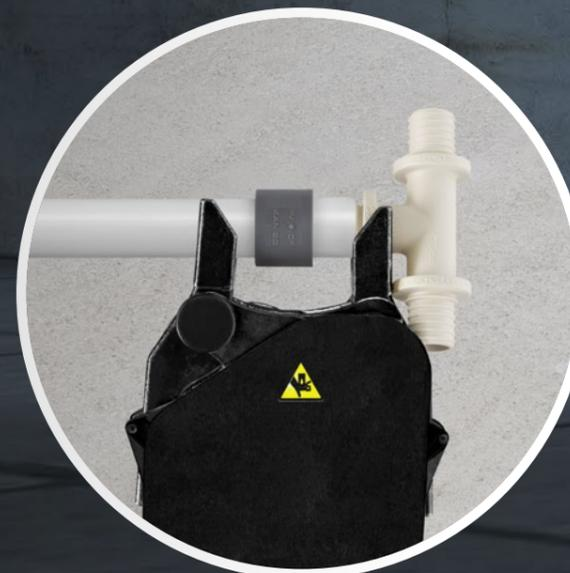
**04 c** Il est possible d'enficher les manchons à l'aide d'outils électriques, typiques des raccords « Press ».
