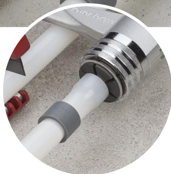
**02** Montez le manchon sur le tube. Montez une tête adaptée au type de tube et à son diamètre sur un évaseur à main ou sans fil.
